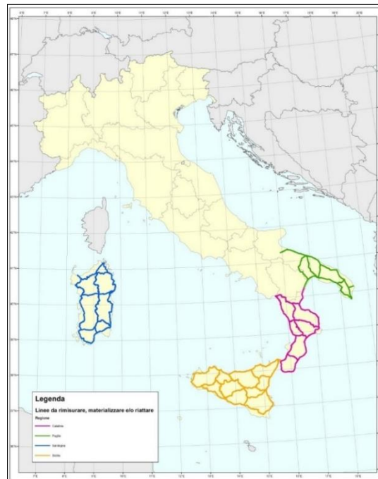
Figura 42 - Linee di livellazione di alta precisione ad alta priorità
