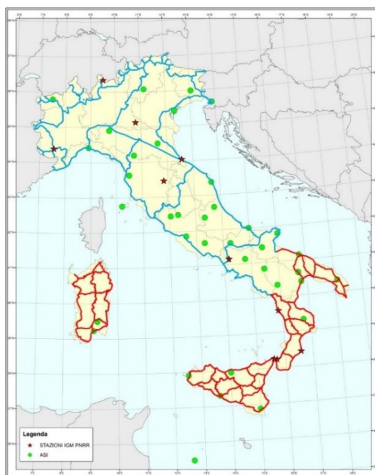
Figura 44 - Stazioni permanenti GNSS da collegare, ove possibile, a linee di livellazione di alta precisione
