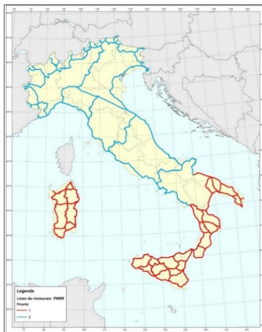
Figura 43 - Linee di livellazione di alta precisione da rimisurare
