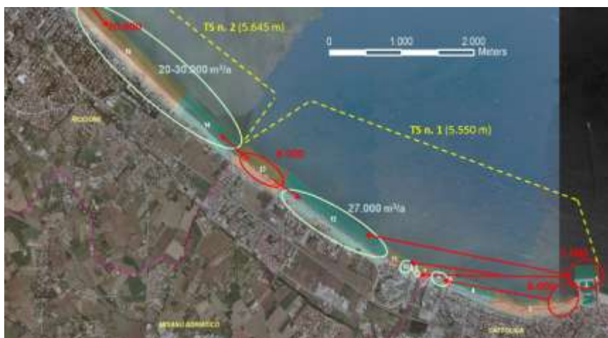
Figura IV.2.2.5.3- Esempio di "Tratti Significativi ai fini gestionali" in Emilia-Romagna: in chiaro i volumi annuali stimati necessari per manutenzione Cella in erosione, in rosso i volumi annualmente disponibili (SICELL). Si noti in questo caso come la disponibilità di sedimenti litoranei in TS1 sia inferiore al fabbisogno annuale.
