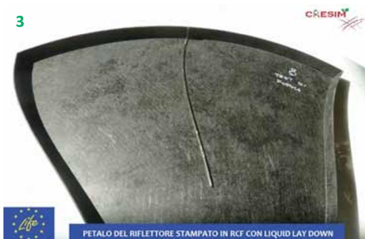
Foto 1: Prototipo di antenna parabolica da campo componibile, per trasmissione satellitare, in fibra di carbonio riciclata, con peso complessivo di circa 6,3 kg e diametro 1,3 mt. (Foto: Pino Tritto - Cannon Communication © Cannon Group - 2014)
