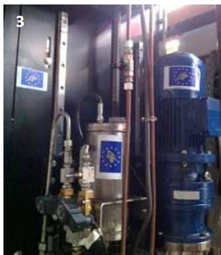
Foto 1: sistema messo a punto da ICCOM CNR Pisa per la dimostrazione a livello di laboratorio delle proprietà sorbenti del mercurio del carbone SOREME (Foto: Emilia Bramanti)
