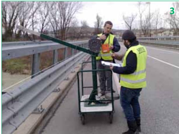
Foto 1: installazione sonda multiparametrica (Foto: Claudio Serrani)
