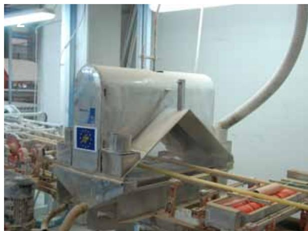
Foto 1: prototipo dell'impianto di deposizione dello strato protettivo polimerico mediante spruzzatura (Foto: Vito Antonio Remigio)
