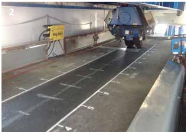
Foto 1: Stesa di prova di conglomerato bituminoso contenente polverino da PFU (Foto: Politecnico di Torino)
