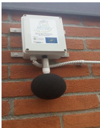
Figura 5 – Sensore smart della rete di monitoraggio acustico low cost (foto: staff LIFE MONZA)
