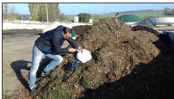
Foto 4 – Controllo dei parametri gassosi in fasi di maturazione (Fonte: LIFE Agrised)
