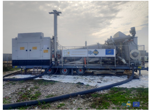
Figura 1: Cavitatore mobile: il prototipo, realizzato nell'ambito di LIFE DOP, è un dispositivo che attraverso la vagliatura, triturazione, cavitazione dei reflui (liquami e letami) agevola la valorizzazione nella filiera della digestione anaerobica (foto: staff LIFE DOP)
