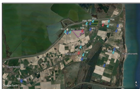
Figura 4: I 23 nodi della WSN AGROWETLANDS nell'area di progetto, compresa tra l'abitato di S. Alberto e quello di Casalborsetti, in provincia di Ravenna. I 9 nodi di tipo P, in colore azzurro, sono attrezzati, ciascuno, con un sensore per l'acqua di falda e almeno un sensore per il suolo; i nodi P02 e P07 sono inoltre attrezzati con una stazione meteorologica. Gli 11 nodi di tipo I, in colore blu, sono attrezzati, ciascuno, con un sensore per l'acqua dei canali. I 3 nodi di tipo S, in colore rosso sono attrezzati, ciascuno, con un sensore per il suolo. I sensori per l'acqua, ne misurano conducibilità elettrica, livello, temperatura. I sensori per il suolo ne misurano umidità, conducibilità elettrica, temperatura. (Foto: LIFE AGROWETLANDS II)
