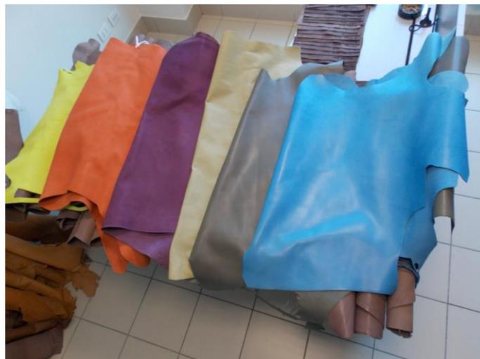
**Progetto Bionad - Pelli tinte con coloranti naturalizzati**
