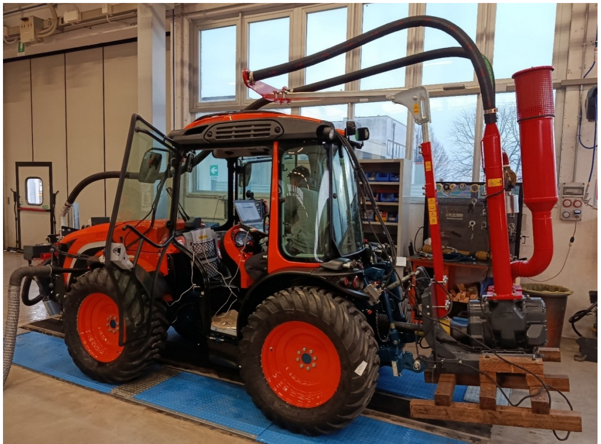
Figura 5. Prototipo full hybrid con defogliatore elettrificato.
