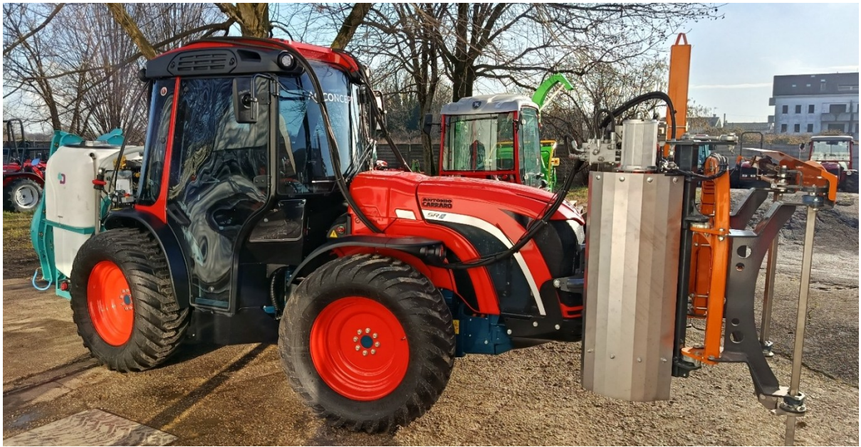
Figura 4. Prototipo full electric con spruzzatore e pre-potatore elettrificati.
