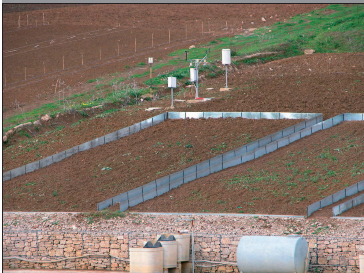
Figura 3 - Sparacia (Sicilia). Parcelle Wischmeier attrezzate per la misura dell'erosione del suolo
