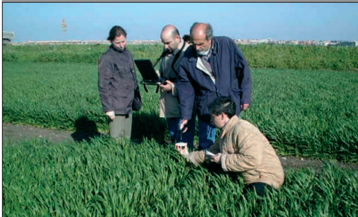
Figura 12 - Basilicata. Campagna di rilievo con spettroradiometro per la stima della frazione gap del fogliame e quindi ricavare il LAI ( www.riade.net ).
