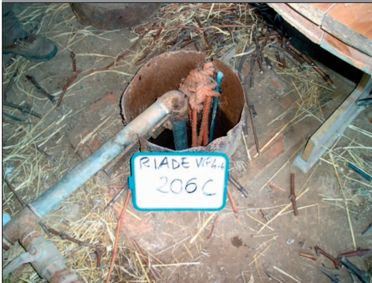
Figura 8 - Nurra, Sardegna. Prove di pompaggio nei pozzi per il monitoraggio delle acque sotterranee (www.riade.net).
