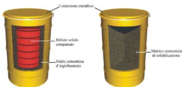
Figura 15: Condizionamento eterogeneo ed omogeneo in matrice cementizia
