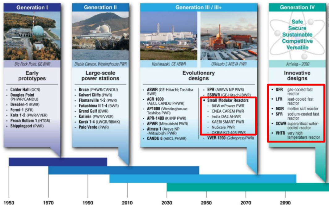
Figura 18: Sinottico dell'evoluzione dei reattori di potenza (fonte: https://www.gen-4.org/gif/ ). I rettangoli rossi indentificano a sinistra i modelli di reattori avanzati in fase avanzata di sviluppo o in costruzione e destra le sei famiglie di reattori identificate dal Generation 4 International Forum GIF.
