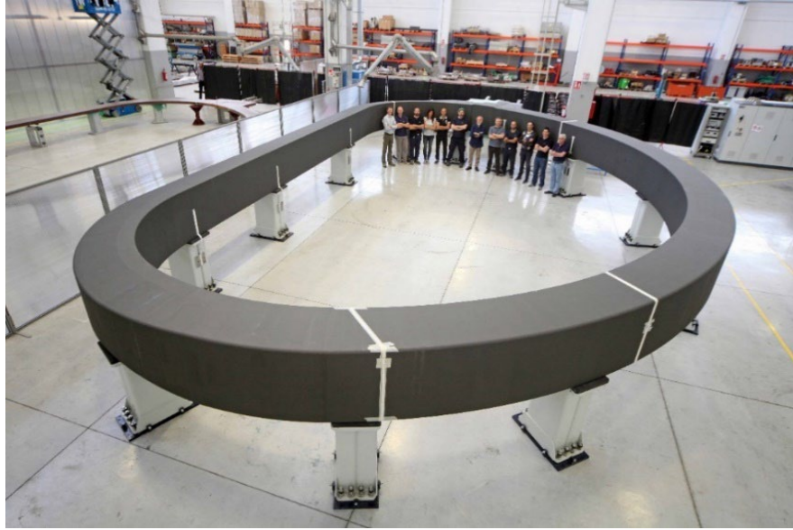
Figura 8. Avvolgimento di una delle 10 bobine che costituiscono il magnete toroidale di ITER realizzate a Genova da ASG Superconductors SpA.
