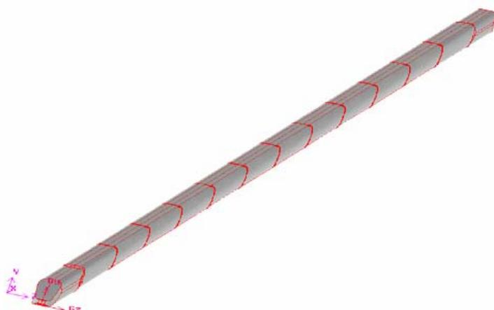
Per diminuire al massimo i tempi di calcolo, il volume di controllo è stato costruito in forma elementare ma con dimensioni tali da poter contenere efficacemente le turbolenze laterali superiori e posteriori dovute al moto del corpo nell'aria. La geometria in esame è stata poi sottratta al suddetto volume, producendo l'effetto di ostacolo al movimento.
