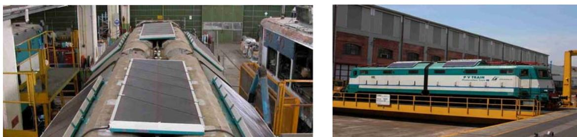
Sull'*Automotrice Aln 668* sono stati installati nove moduli US116 collegati in serie (tre a tre formando 3 file di serie ciascuna) e, quindi in parallelo.
